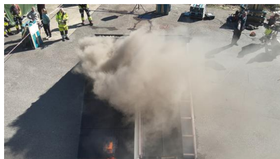
Kraftig røykutvikling fra venstre inndeling i takriggen. Etter ca. 4,5 min. brant det hull gjennom plast-glass panelene. Foto: DLE Lnett.
