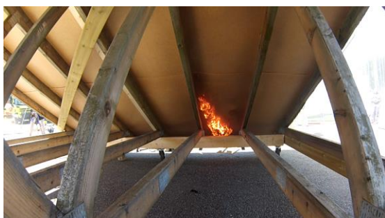
Brann gjennom sutaksplatene i inndeling uten gips Foto: Lene Nyberg, RBR
