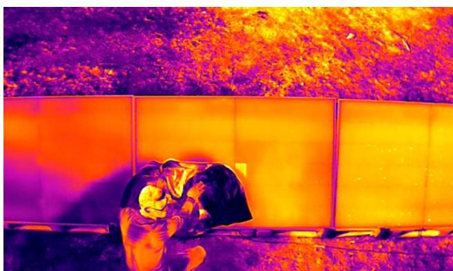
Bilder viser "hot spot" ved delvis tildekking av panel.
